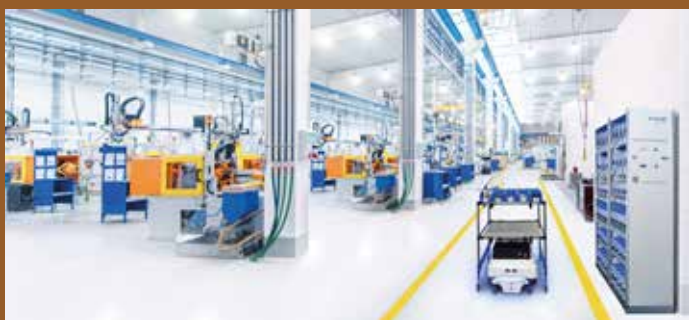
Last mile management-konceptet handler om at designe en løsning med kasser med C-varer helt ude på de enkelte produktionslinjer. Det forbedrer den interne logistik. Foto: Bossard.
